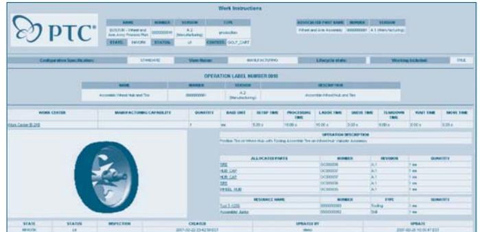
Windchill MPMLink 动态生成内嵌有 3D 轻量图形的工作指令。
